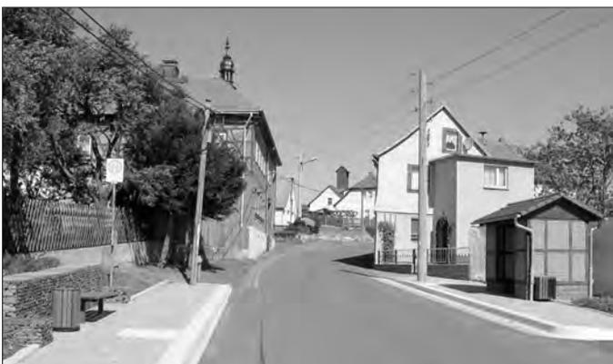
Entstanden sind neben einem Buswartehaus in massiver Fachwerkbauweise zwei gepflasterte Flächen mit Sonderbord für einen behindertengerechten Zugang.
